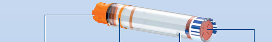
Extrémité filetée (pour attacher l'aiguille) Bande de couleur Bille de verre (uniquement pour les suspensions d'insuline) Piston
